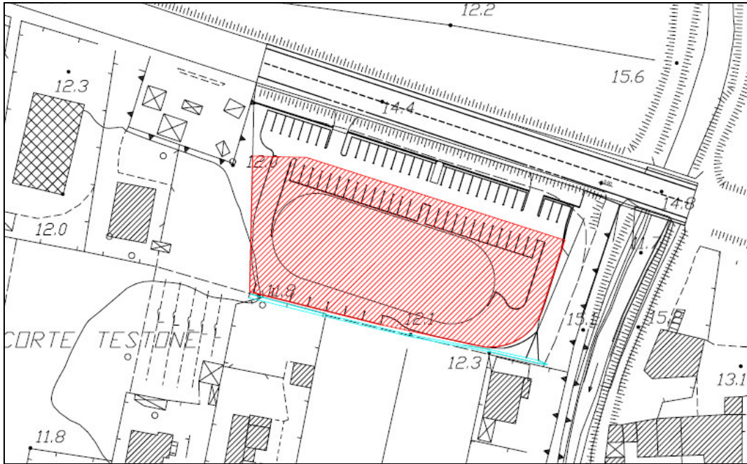
Figura 7 Pianta schematica della superficie interessata dalla vasca in progetto. In celeste la scolina esistente
