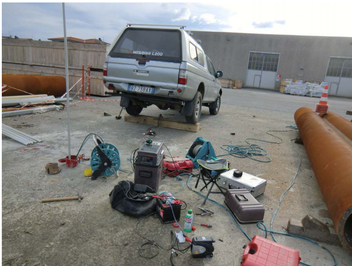
DHS1 – Sito in studio e strumentazione utilizzata per l'esecuzione della indagine sismica in foro. In primo piano il sismografo Geometrics Stratavisor NZXP a 48 canali usato per l'acquisizione del segnale sismico.
