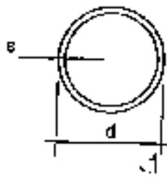
Tubi in acciaio zincato elettrolitico con riparo di zinco sulle saldature. Materiale: acciaio zincato a caldo in seconda DIN EN 10203 e 10210. Tolleranza di lunghezza: -0,15 mm per barre da 3 m -0,50 mm per barre da 4 m.
