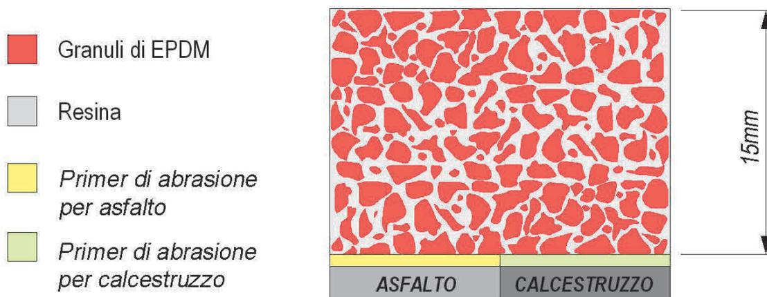
Pavimentazione drenante, antiscivolo, permeabile, resistente al fuoco, a manto continuo gettato in opera su sottofondo esistente in calcestruzzo o asfalto.
